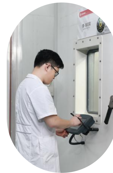
ドイツのVOTSCHウォークイン気候模擬試験箱
